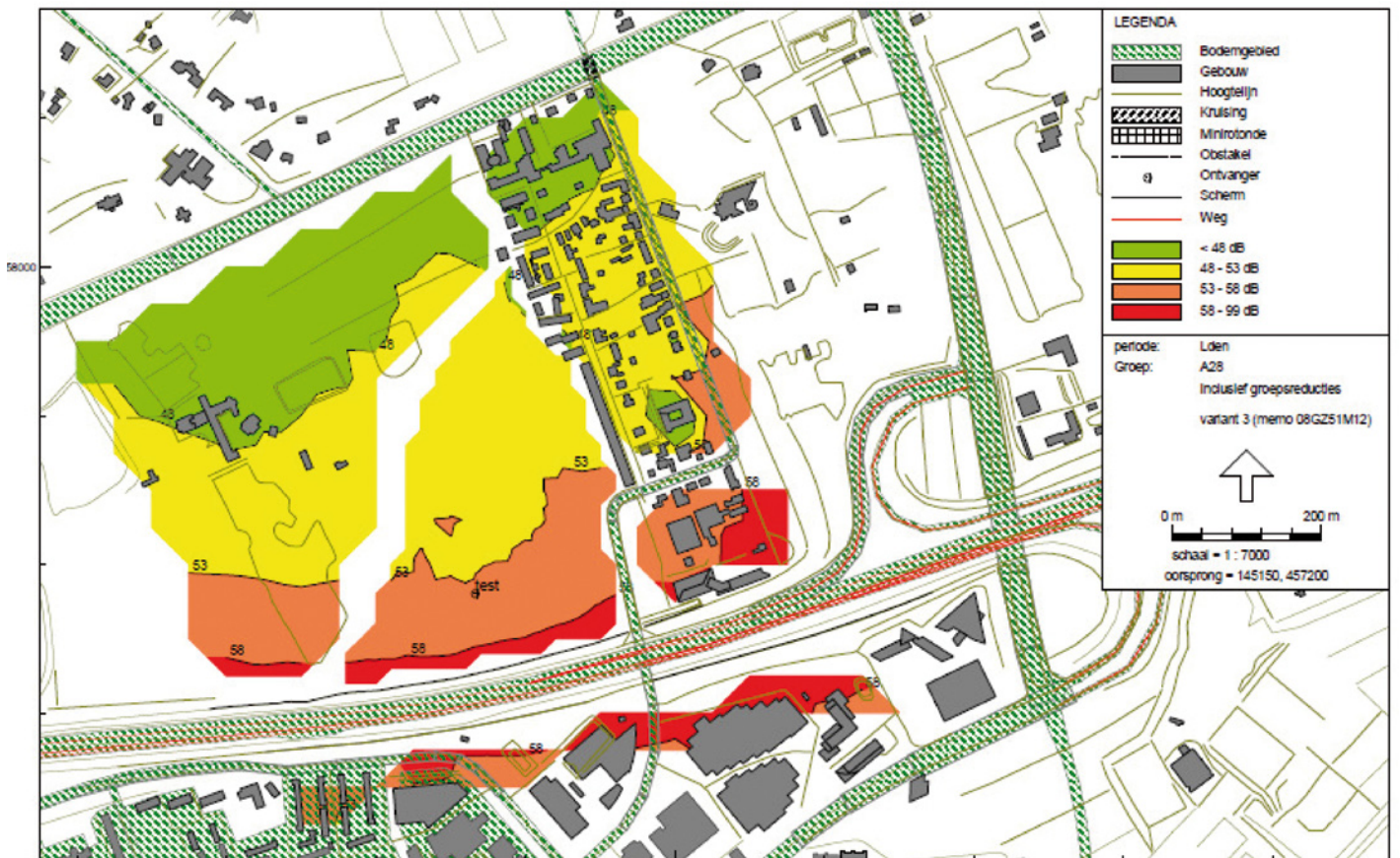
Figuur 2: Geluidsbelasting Huis ter Heide na realisatie geluidswering met een hoogte van 3 meter.
