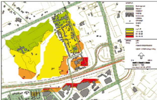
Figuur 3: Geluidsbelasting Huis ter Heide na realisatie geluidsschermb met een hoogte van 3 meter
